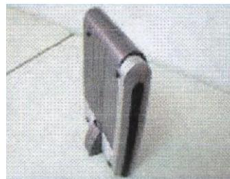
Para convertir una señal digital en otra analógica, el módem genera una onda portadora y la modula en función de la señal digital. El tipo de modulación depende de la aplicación y de la velocidad de transmisión del módem. Un módem de alta velocidad, por ejemplo, utiliza una combinación de modulación en amplitud y de modulación en fase, en la que la tasa de la portadora se varía para codificar la información digital. El
