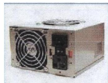
ellas una para conectores de placa AT. Muchas personas identifican la fuente AT porque poseen dos conectores que van a la placa base y la ATX porque solo poseen un conector y el apagado de la placa base es automático.
